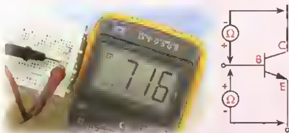
Figura 8.8b. Prueba de las uniones BE y BC en polarización directa
